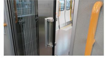
車内は気密性が高く、走行音が大幅に軽減。空調設備もグレードアップし快適にご利用いただけます。また車内で移動する際に開け閉めする扉は、軽力で開けられるように取っ手を改良しています。
