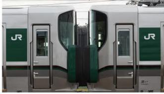
227系は車両を連結して運行する場合があります。ホームから線路に転落することを防止するホクを先頭車両にも取り付けています。
